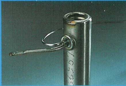
Verschiedene Schweißstellen an einem Kühlmantel.
