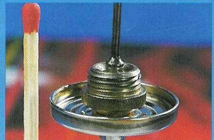
Membrangehäuse und Anschlussröhrchen, geschweisst im Mikroplasmabereich.
